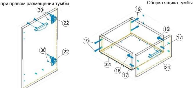
По фасаде тумбы имеются два несвозных отверстия сверху и снизу под ручку и 4 отверстия под петли. Если фасад будет находится с правой стороны, то петли - справа и ручка сверху. Если фасад - с левой стороны, то вы его переворачиваете. Петли остаются на месте, а ручка будет в другом положении. С обратной стороны фасада сделаны несквозные отверстия под чаши петли. Устанавливаем петли (поз.22) и крепим саморезами при помощи шуруповерта.
